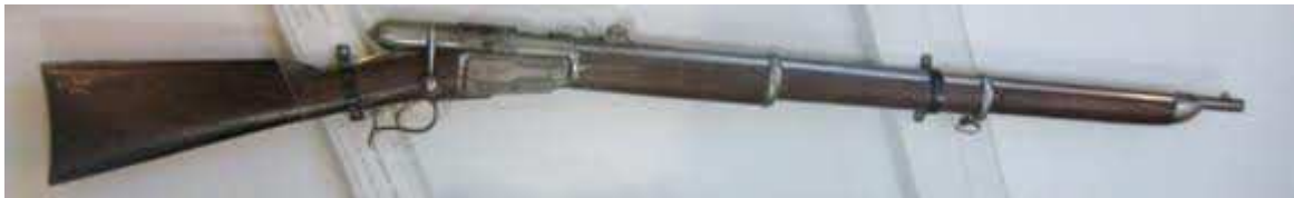
Repetiergewehr Vetterli, Modell 1869. Waffe der Infanterie, modifiziert 1871, 1878 (Säbelbajonett) und 1881. Kaliber 10,4 mm, Randfeuerpatrone; Röhrenmagazin im Vorderschaft für 11 Patronen.
