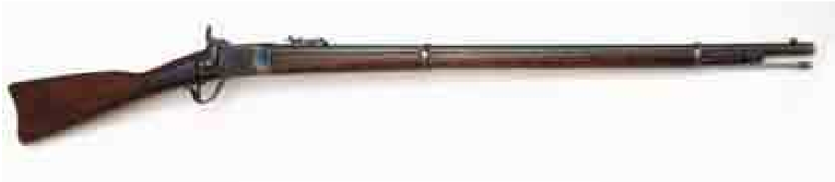
Peabody-Gewehr, Modell 1867. Waffe der Scharfschützen. Kaliber 10,4 mm; Randfeuer-Metallpatrone. Erster Hinterlader unserer Armee, aus Amerika beschafft (Patent von 1862).
