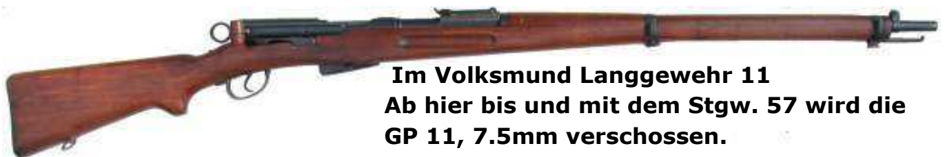
Infanteriegewehr, Modell 1911. Eidgenössische Waffenfabrik Bern. Kaliber 7,5 mm (Spitzgeschoss); Visierbereich 300 bis 2000 Meter; Kastenmagazin für 6 Patronen.
