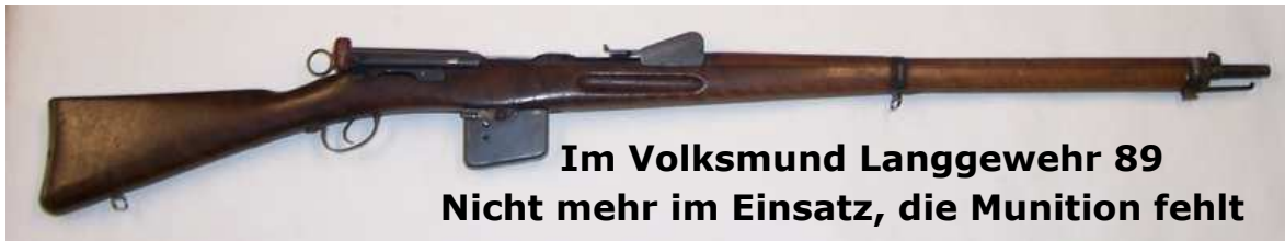
Infanteriegewehr, Modell 1889. System Schmidt-Rubin. Eidgenössische Waffenfabrik Bern. Kaliber 7,5 mm; Visierbereich 300 bis 2000 Meter; Geradzugverschluss; Kastenmagazin für 12 Patronen.
